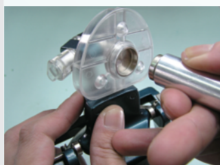
Отделите магнит верхней пластины, используя специальное приспособление
