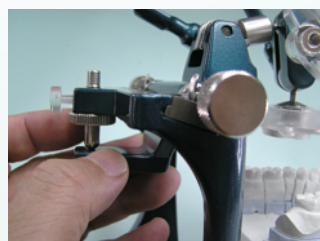
Установите верхнюю пластину параллельно нижней
