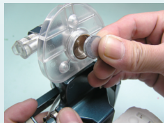
Установите магнит в верхнюю установочную пластину
